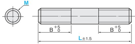
■材質 S45C ■硬度 25~35HRC ■表面処理 四三酸化鉄皮膜
